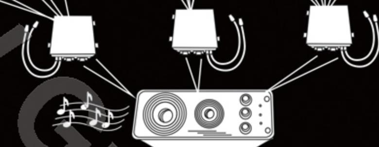
Эта схема показывает, как несколько контроллеров обеспечивают светомузыкальный перелив целого квартала в одной сети. Данная система позволяет, кроме синхронизации с музыкой, обеспечить включение и выключение по дате и времени.
